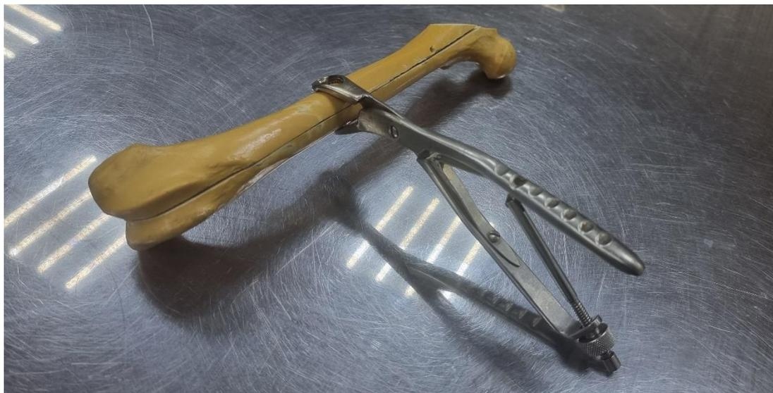
Рисунок 91 – Фиксация смоделированного продольного перелома бедренной кости (муляж кости)
